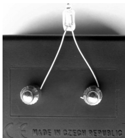
Obrázek upevnění testovací výbojky.
